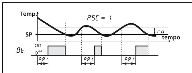
O segundo controle prevê a inibição da saída "ot" por um intervalo mínimo configurado no parâmetro "P.P2", depois que a saída foi desligada (retardo após desligamento ou tempo mínimo de compressor desligado).
