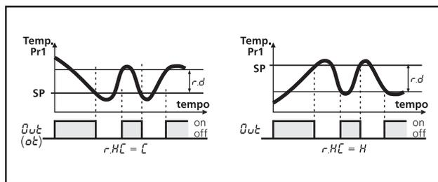
Em caso de erro de medida da sonda, é possível que a saída configurada como "ot" continue funcionando ciclicamente de acordo com o tempo configurado parâmetro "r.t1" (tempo da saída ligada) e "r.t2" (tempo da saída desligada).
