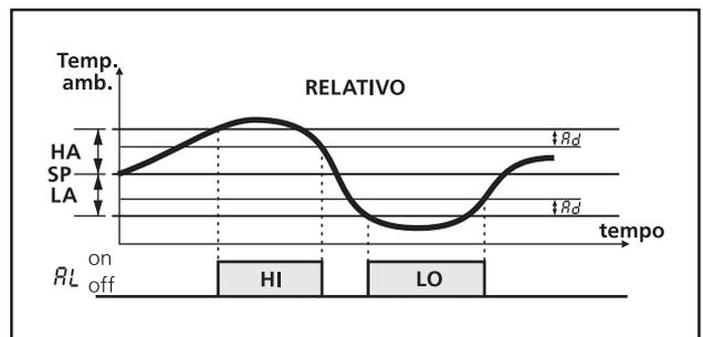
Os alarmes de temperatura podem ser desabilitados configurando os parâmetros "R.HR" e "R.LR" = oF.
